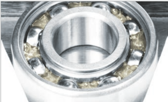
Bild 2: Der Schmierstoff im Wälzlager soll die Reibung reduzieren und Verschleiß verhindern oder zumindest mindern.
